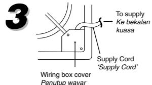
**3** Connect the wires to the house's supply according to connection diagram shown. Sambungkan wayar kepada bekalan rumah seperti gambar rajah sambungan yang ditunjuk.
